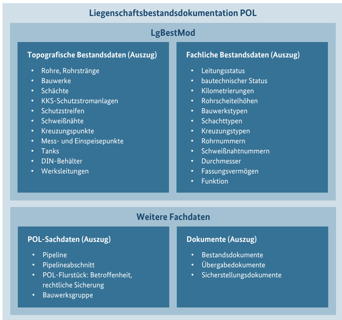
Abb. 7 Inhalt der Liegenschaftsbestandsdokumentation des Fachbereichs POL
